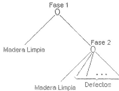
Figura 3: Esquema de Clasificación Secuencial usado para minimizar la carga en la solución del problema de la detección de defectos.
